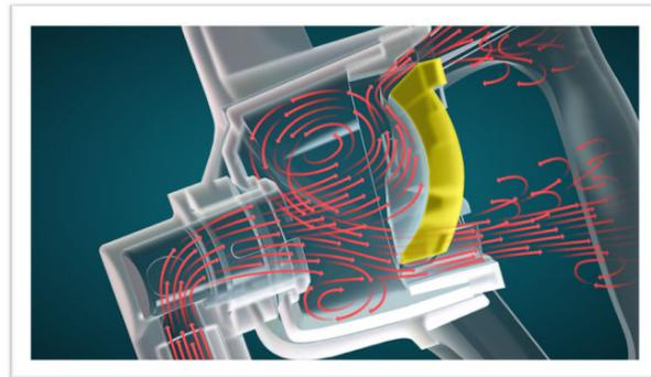
Profil latéral de la dynamique du débit d'oxygène à travers les orifices directionnels vers la bouche et le nez (déflecteur mis en évidence).
